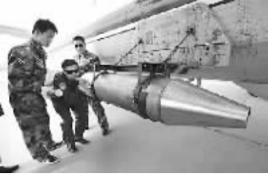
3月29日,机务人员给飞机加挂人工增雨弹。当日,成都军区空军驻蜀人工增雨小分队抓住有利天气实施人工增雨。
