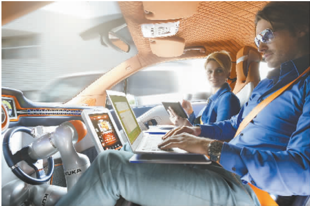
瑞士汽车咨询公司Rinspeed此前曾推出极具创意的无人驾驶汽车概念,该款概念车看上去就像是一款运动版的宝马i3,配备一台电动机,前排乘客可同时利用方向盘控制汽车,而乘坐者则可以通过一个灵敏的机械手臂进行操控。 东方IC供图
