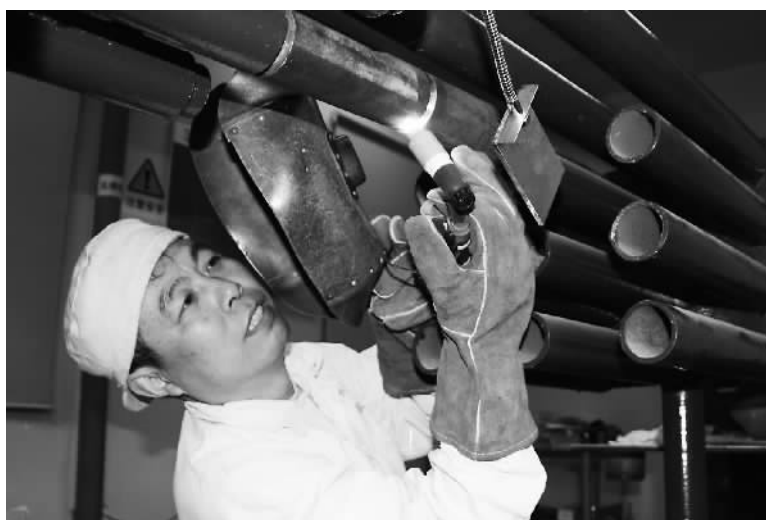
图为季小燕在进行镜面焊接操作。董勤摄
