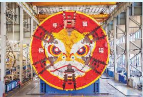
日前,一台刀盘涂装着醒狮图案的大直径盾构机"深 江1号"在长沙下线。这台盾构机由中铁十四局和中国 铁建重工集团自主研发打造,开挖直径达13.42米,将参 与我国最深海底隧道——深圳至江门铁路珠江口隧道工 程建设。
