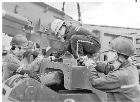
随着产能升级和技术改造,曾经靠“手挖肩挑”的小煤矿也有了大型综合机械化掘进机。图为技术人员正在调试鑫鑫煤矿的综合掘机。
