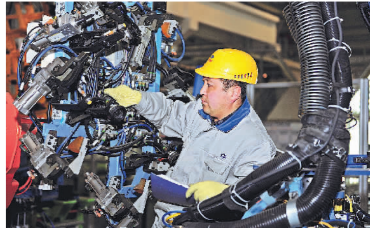
图为齐嵩宇在维修多车型组合夹具管线。受访者供图
