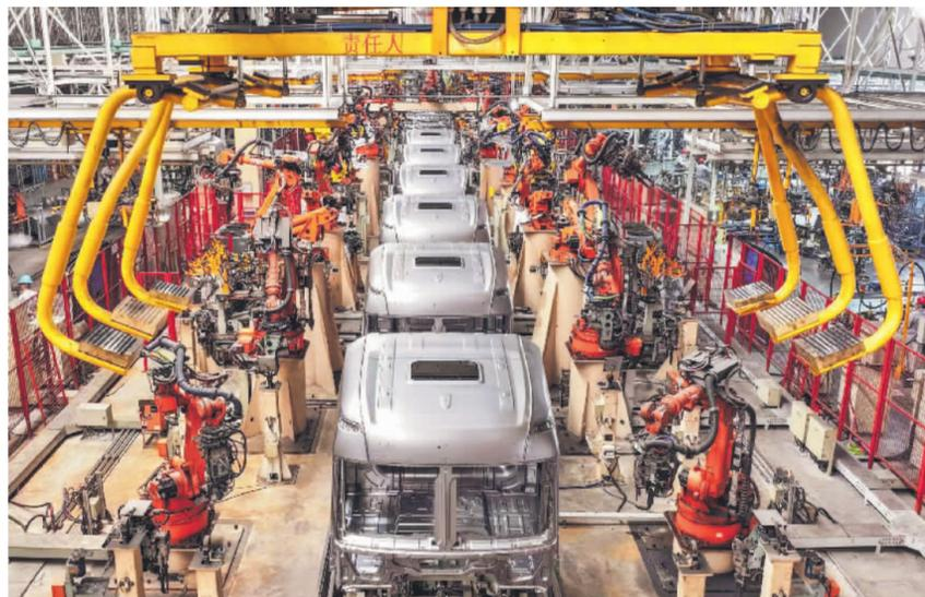
→5月7日,安徽省马鞍山经开区汉马科技重卡全自动焊接生产线上,工业机器人在进行焊接作业。近年来,马鞍山抢抓新能源汽车产业快速发展机遇,当地企业加大转型升级步伐,发展新质生产力,开发的新能源重卡畅销国内外市场。 本报通讯员 王文生 摄
