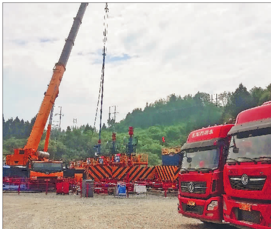
6月13日,在涪陵页岩气田焦页162平台,14台电驱压裂机组正在紧张进行压裂作业。 本报记者 刘津农 摄
