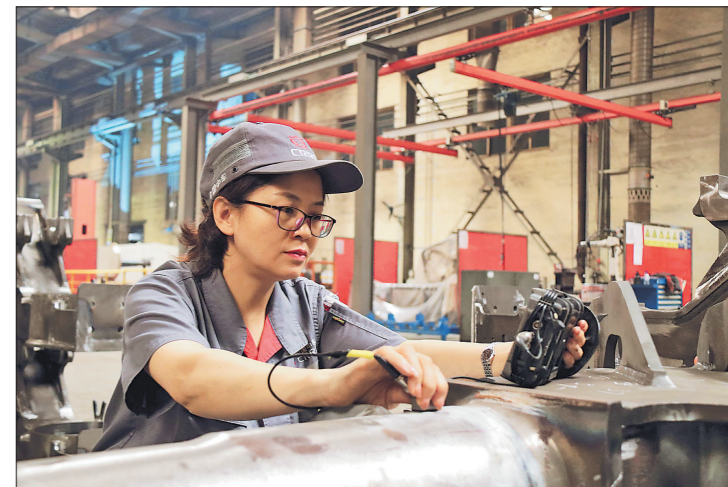
王丽萍正在用超声波检测仪对转向架构架及其零部件做检测。 中车长客供图
