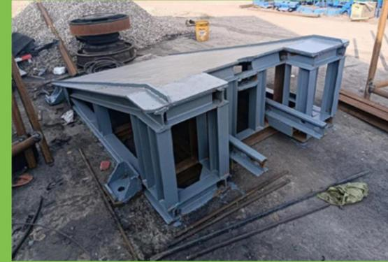
利用矿上现有钢板、工字钢和废旧轨道等材料加工了2个爬车器
